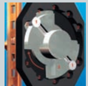
Nel corso della manovra i bulloni di sicurezza vengono presi Da elementi accoppiati (3) e portati all'alloggiamento Successivo.
